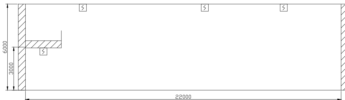
Рис. 4.3.25. Схема размещения точечных дымовых пожарных извещателей в разрезе помещения
